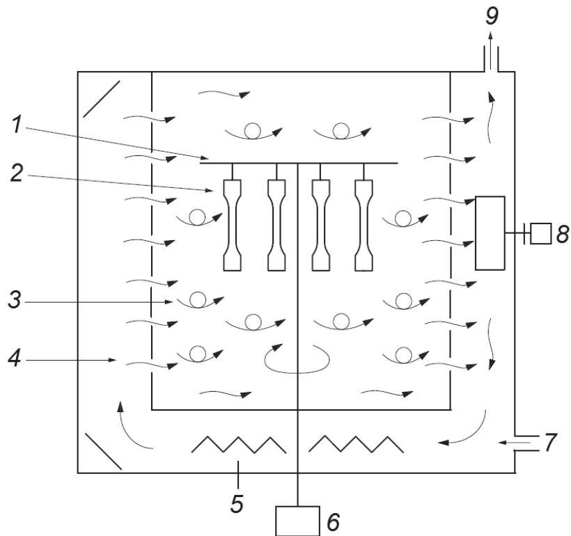
1 – держатель образцов для испытания; 2 – образцы для испытания; 3 – турбулентный поток воздуха; 4 – ламинарный поток воздуха (впускное и выпускное отверстия – рядом со стенками); 5 – нагревательный элемент; 6 – электродвигатель; 7 – выпускное отверстие для воздуха; 8 – нагнетатель воздуха; 9 – выпускное отверстие для воздуха
