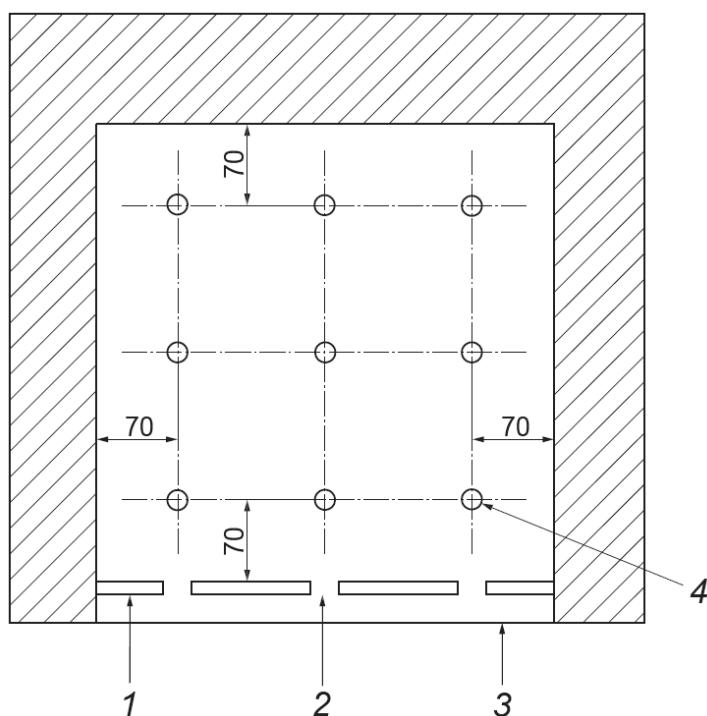
1 – пластиковая пластина; 2 – отверстие; 3 – проем дверцы; 4 – точка измерения
