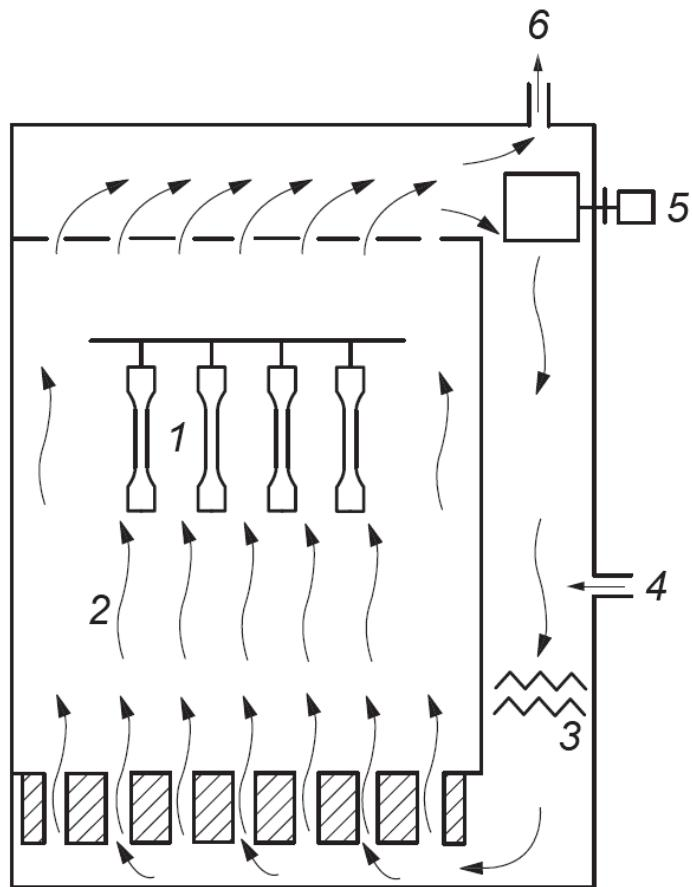
1 – образцы для испытания; 2 – ламинарный поток воздуха; 3 – нагревательный элемент; 4 – выпускное отверстие для воздуха; 5 – нагнетатель воздуха; 6 – выпускное отверстие для воздуха
